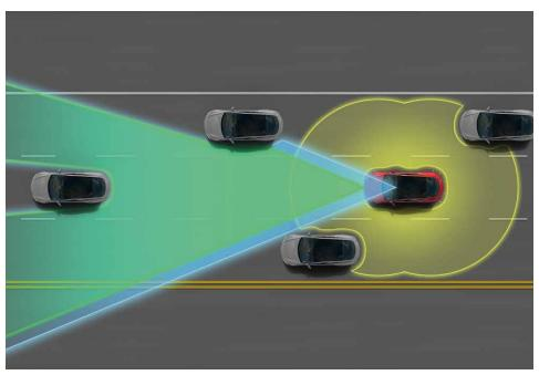
Рисунок 25 – Принцип работы системы автопилота автомобиля Тесла
