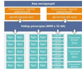
Рисунок 6 - Архитектура CUDA NVidia
