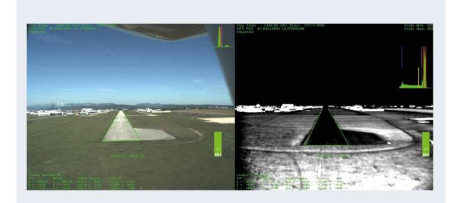
Рисунок 26 - Автономная система посадки самолёта Мюнхенского Технологического Университета
